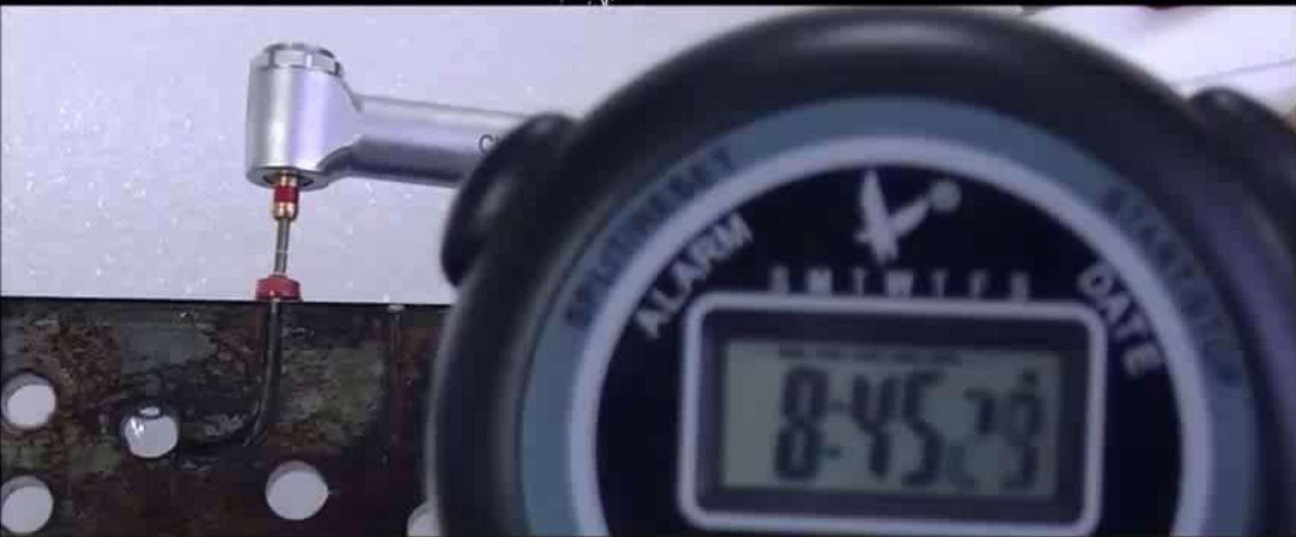
SC-Pro在90° 弯曲钢管下，375rpm连续旋转10分30秒。
